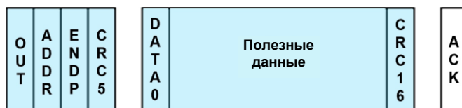
Рисунок 13-79 – Пример передачи bulk OUT. Синий: пакет хоста, белый: пакет устройства
