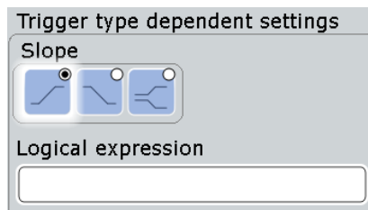
Рисунок 14-1 – Настройки запуска по фронту для источника запуска в виде комбинации цифровых каналов (Logic)
