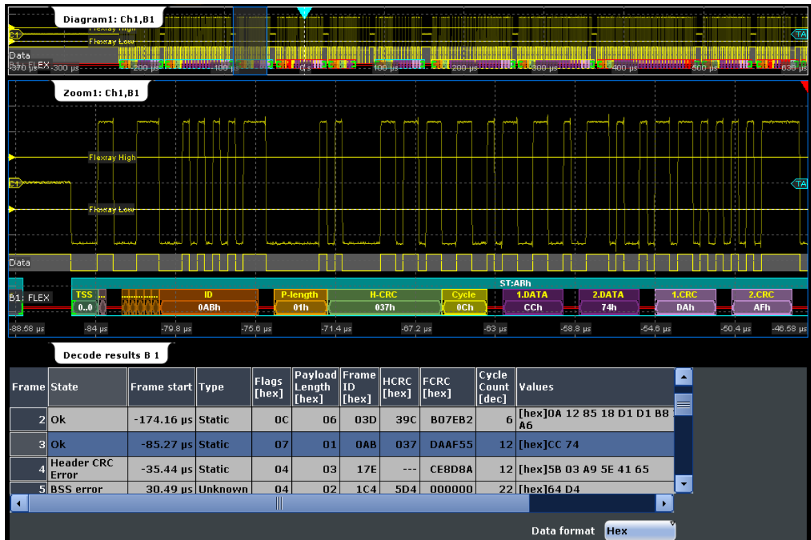
Рисунок 13-35 – Шина FlexRay: декодированный динамический слот и таблица результатов
